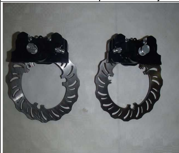
Photo du frein avant : étriers et disques seulement Photo of front brake: calipers and discs only
